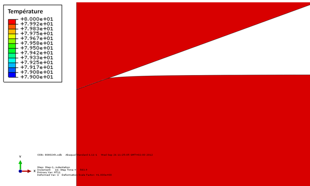
FIGURE 2.9 – Distribution finale des températures dans la zone de contact lors du maintien à enfoncement constant durant 24 heures (température de l'air égale à 80 °C). L'équilibre est atteint après un maintien du contact pendant 580 s environ.
