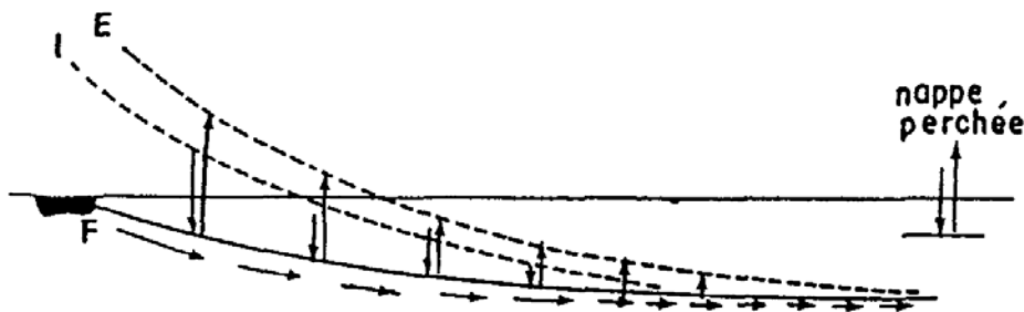
Fig. IV.1 Schéma conceptuel expliquant le déficit infiltration-évaporation et la formation de dépressions piézométriques (Aranyossy & Ndiaye, 1993)
