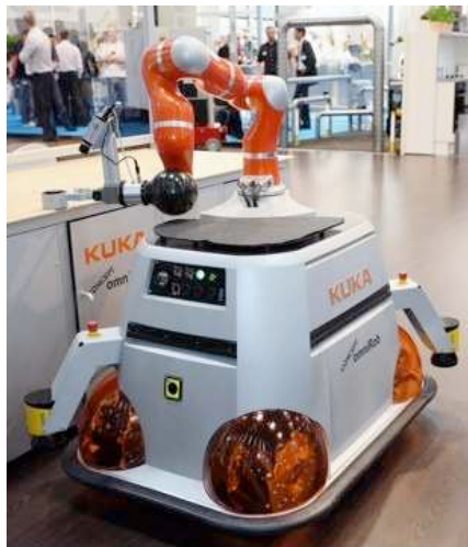
FIGURE 2.9 – Bras motorisé du robot PHRIENDS
