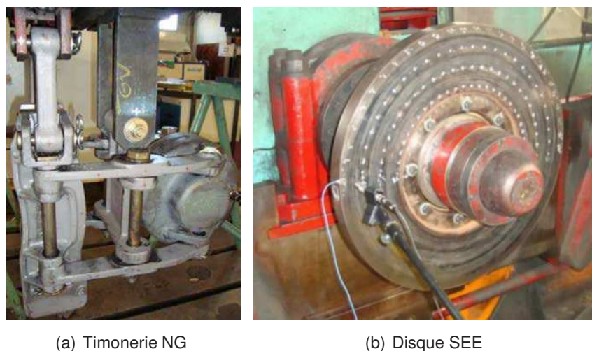
FIGURE 6.1 – Vue des éléments du système réel installés sur le banc d'essai de l'AEF
