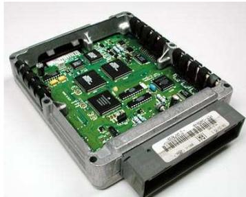
Figure 29. Architecture interne d'un ECU
