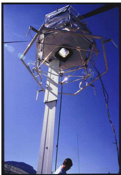
**Figure 2.14.** Photographie de l'instrument SPIRALE vu du dessous lorsque le mat optique est déployé.
