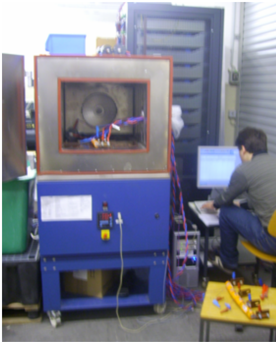
Fig.32. Appareils de mesure employés : banc Digatron, data-logger et enceinte climatique pour les cyclages et la mesure de capacité ( gauche ) ; EISmeter et batteries au plomb en parallèle pour la mesure d'impédance ( droite ).
