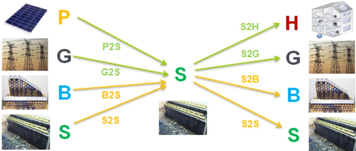
Fig.25. Synthèse des interactions bipolaires mettant en jeu le pôle énergétique du stockage stationnaire (S).
