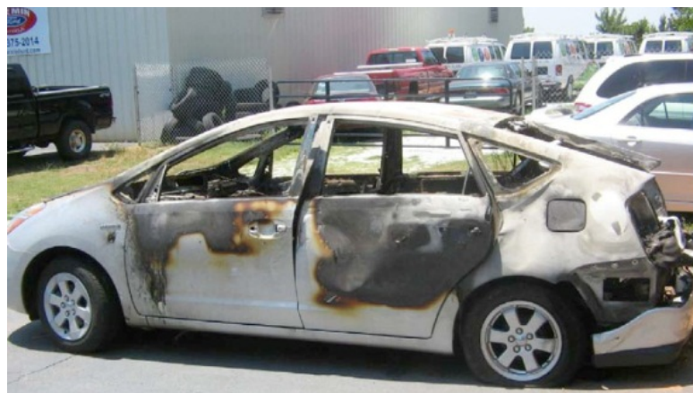
Fig.1-27. Epave de Toyota Prius après un feu de batteries A123System [28].
