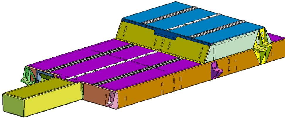
Fig.3-48. Vues externe du caisson retenu pour le pack de batteries du prototype envisagé.
