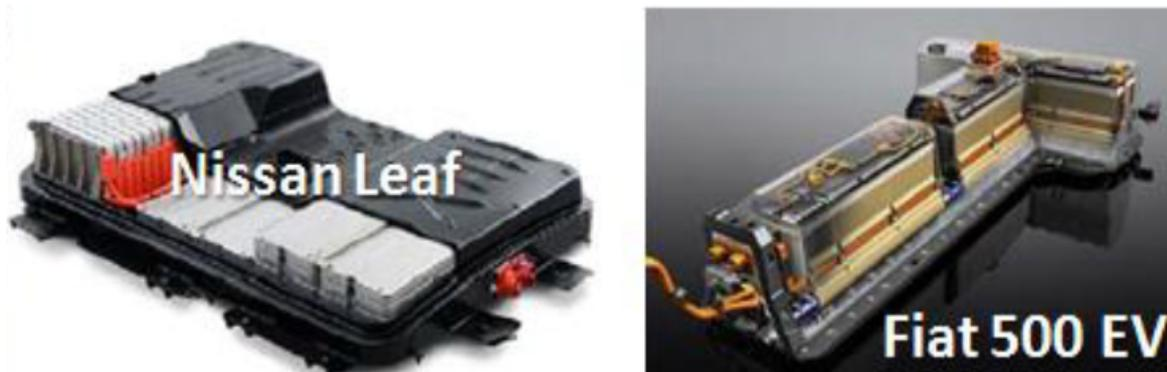
Fig.3-58. Exemples de géométries de packs de batteries de véhicules électriques commerciaux [4].
