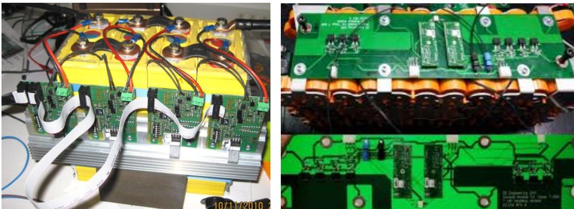
Fig.3-65. Exemples de cartes électroniques assurant la gestion et l'équilibrage d'un pack de batteries [23].
