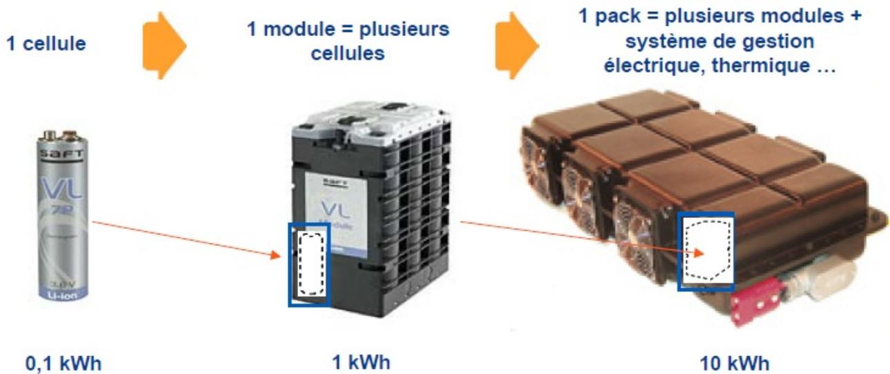
Fig.3-56. Schéma illustratif du conditionnement étagé en poupées russes d'éléments de batteries utilisés comme stockage embarqué ou stationnaire ; l'assemblage en pack n'est pas le même selon l'application envisagée [3].
