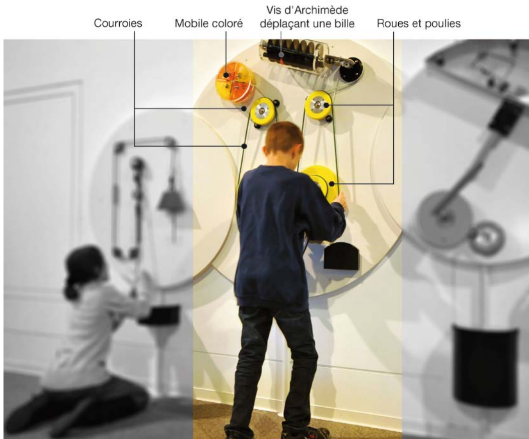
Figure 17. Le dispositif Poulies-Courroies. Selon la disposition des courroies autour des roues et poulies, il est possible de démultiplier la vitesse de rotation de la manivelle (cachée par le visiteur). Il arrive que le visiteur parte sans enlever les courroies de sorte que le visiteur suivant peut imaginer une intrigue à partir d'un dispositif « fermé », un dispositif où les degrés de liberté sont réduits, voire inexistantes.
