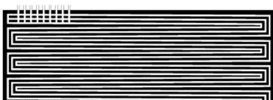
Figure II.4 : Exemple de dessin de plaque bipolaire à canaux, côté air [Scholta JPS 2006].
