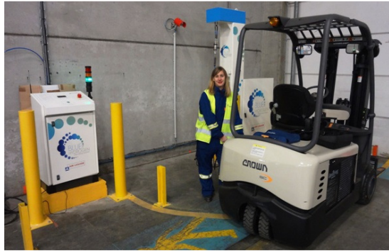
Figure I.12 : Remplissage en hydrogène d'un chariot élévateur à PAC sur la plateforme de Vatry (51). Source : Air Liquide.
