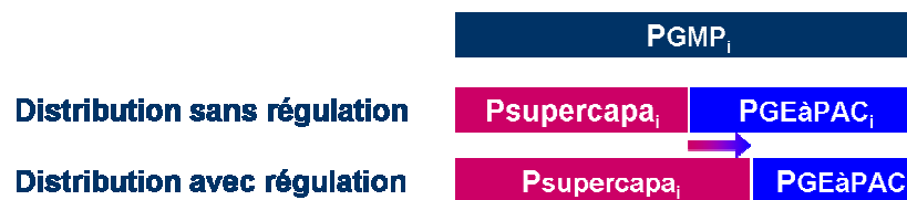
Figure III.19 : Nouvelle répartition de la puissance en fonction de l'état de charge des supercondensateurs (cas d'un état de charge des supercondensateurs élevé).
