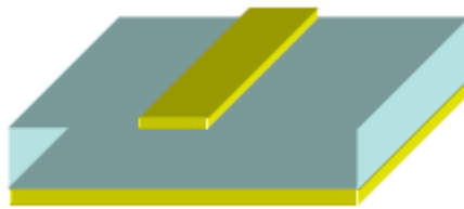
Figure 115 : Schéma d'une ligne micro-ruban
