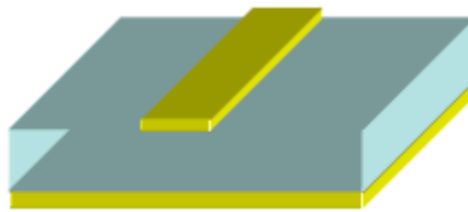
Figure 115 : Schéma d'une ligne micro-ruban
