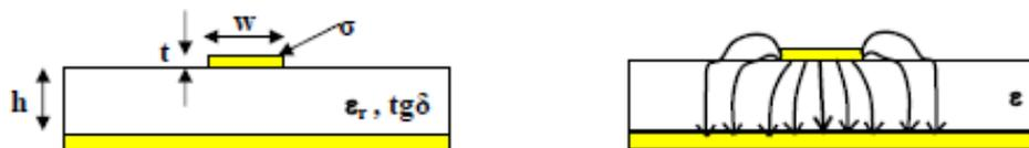
Figure 116 : Paramètres d'une ligne micro-ruban (à gauche) et ses lignes de champs électriques (à droite)
