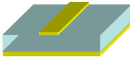
Figure 115 : Schéma d'une ligne micro-ruban
