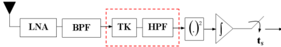
FIGURE 6.11 – Détecteur d'énergie avec l'opérateur Teager-Kaiser [129]
