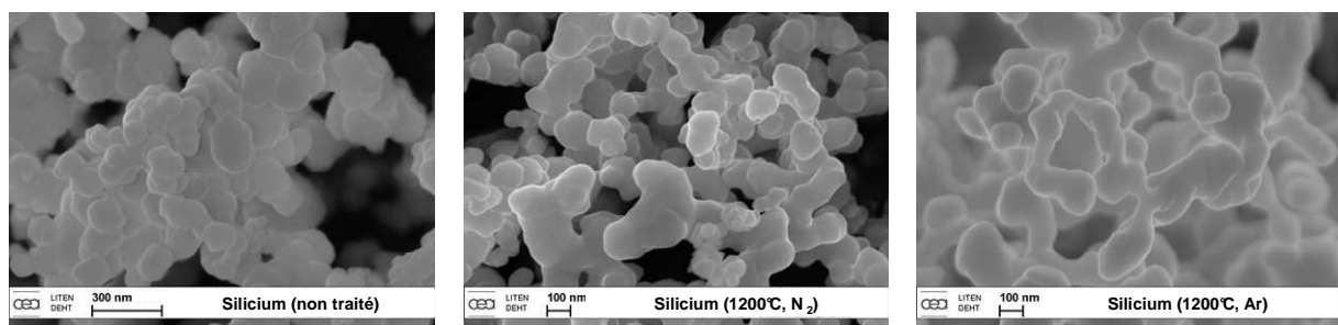
Figure 47 : Clichés MEB du silicium nanométrique (à gauche), du Si [1200°C, azote] (au centre) et du Si [1200°C, argon] (à droite)
