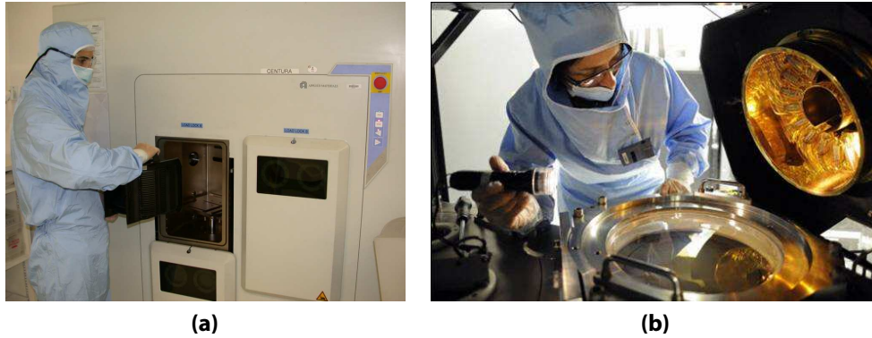
Figure 2.3 – Photos de l'équipement de croissance par CVD Centura 5200. (a) Sas de chargement et (b) Chambre de croissance (montrée ici ouverte lors d'une inspection)
