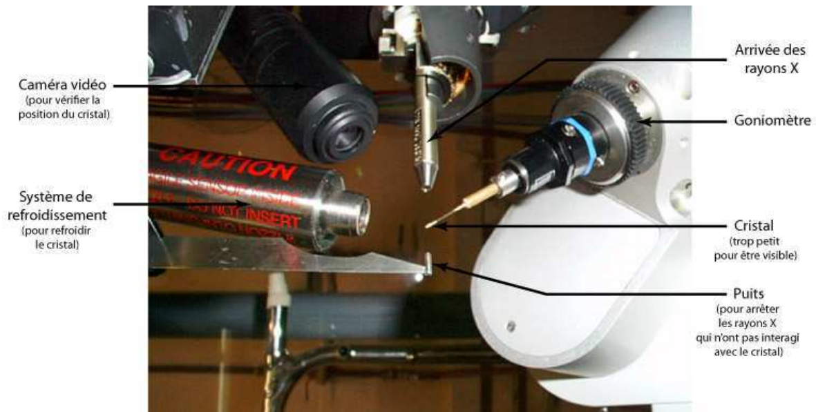
Figure 13 Photo d'un diffractomètre (le détecteur de rayons X n'est pas visible).
