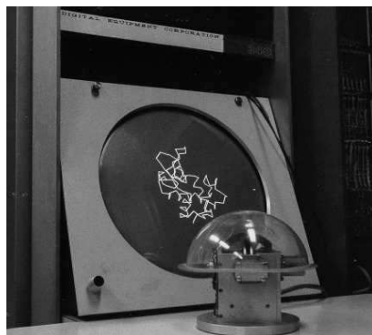
Figure 36 Oscilloscope de Levinthal et son équipe affichant une molécule. Le globe devant permet de contrôler la direction et la vitesse de rotation de l'image.
