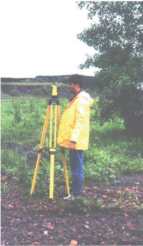
Photo 1 : Implantation du maillage au théodolite.
