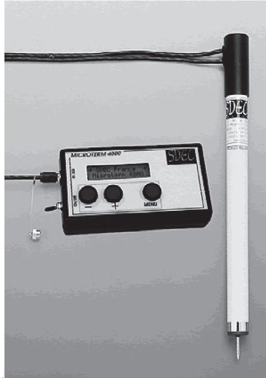
Figure 50 : Humidimètre capacitif pour les sols HMS 9000 développé par l'Institut National de Recherche Agronomique (INRA) d'Avignon (selon : www.sdec-france.com/fr/HMS9000.html )
