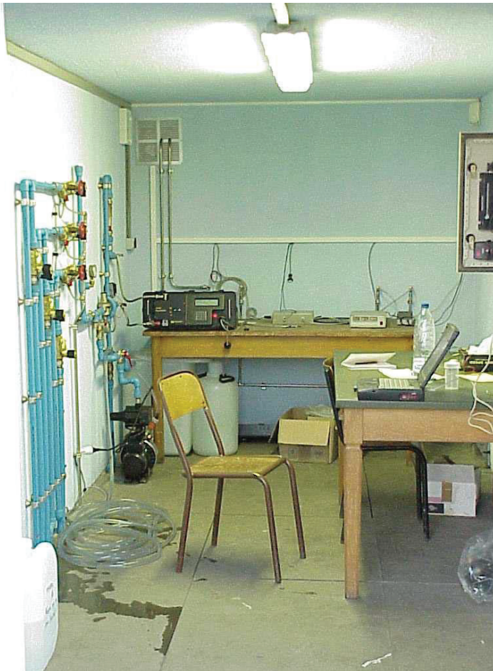
Figure 63 : [a] [c] Aménagement intérieur du local d'analyse : vue d'ensemble [a] ; arrivée conduite, système de rinçage et fluorimètre [b] ; analyseur de biogaz [c].
