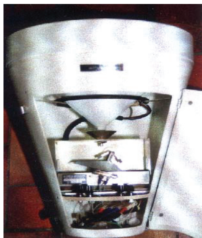
Figure 47 : Pluviographe à augets - fonctionnement (d'après Bertrand-Krajewski, 2002)
