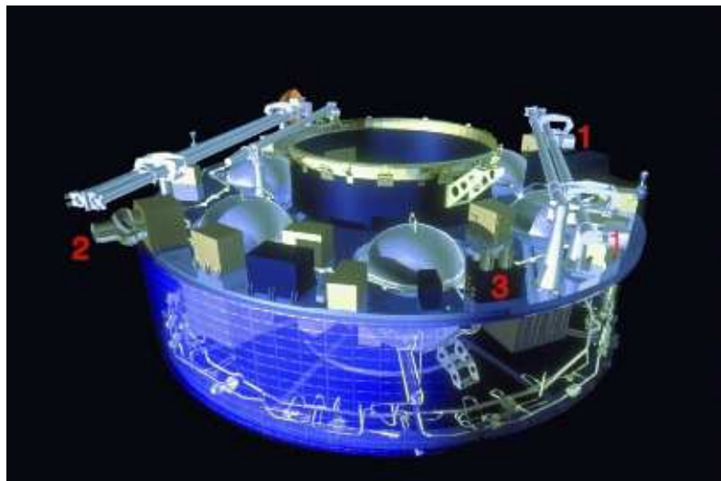
FIG. 2.12 – Représentation d'un des satellites avec position des instruments dédiés à la mesure des champs magnétique et électrique et à celle du potentiel satellite : 1 - FGM, 2 - EDI, 3 - ASPOC.
