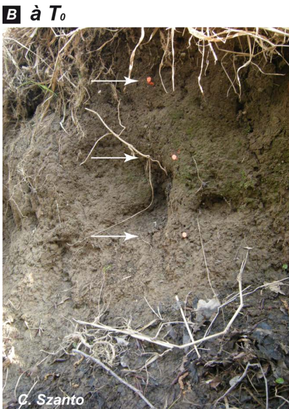
Figure 7.19 : Equipement in situ des berges. Positionnement des profils de berge et équipement à l'aide de tiges d'érosion et de clous (a), mesure des reculs de berges (b).
