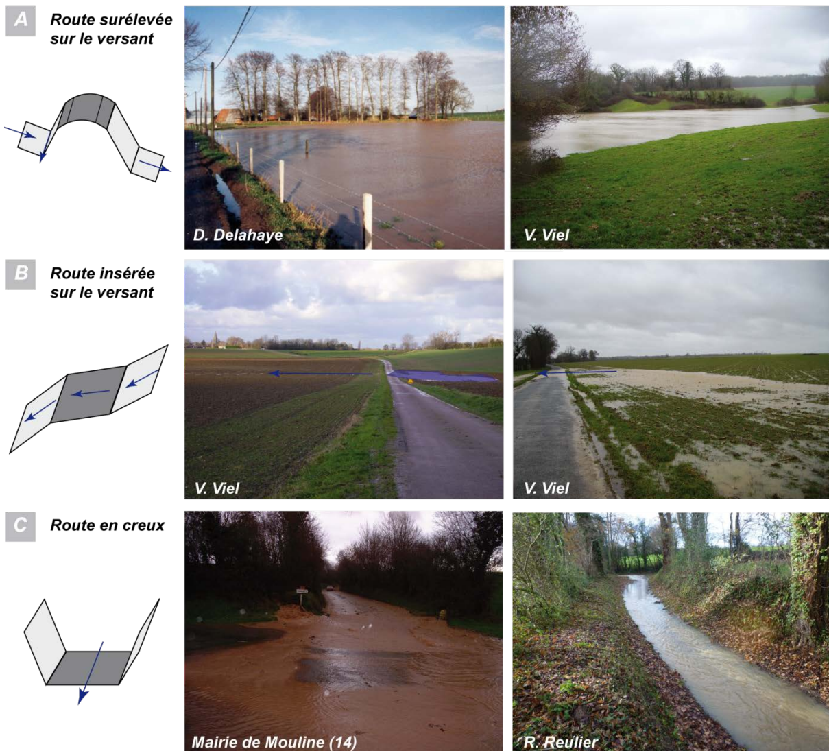
Figure 6.6 : Typologie du rôle hydrologique du réseau routier.
