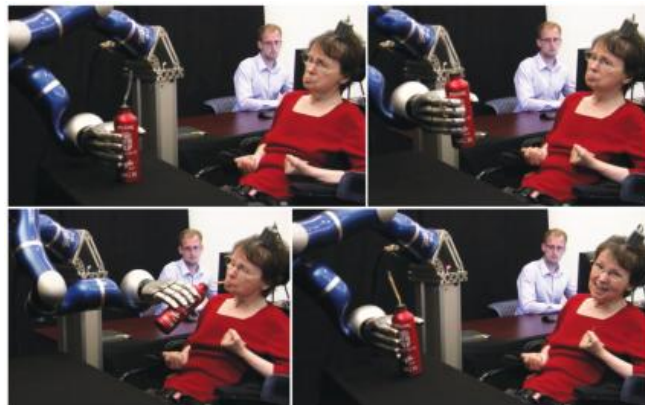
Figure 1.1 : Séquence d'images de l'expérience de contrôle d'un bras robotique dans le projet BrainGate [DONO 12]
