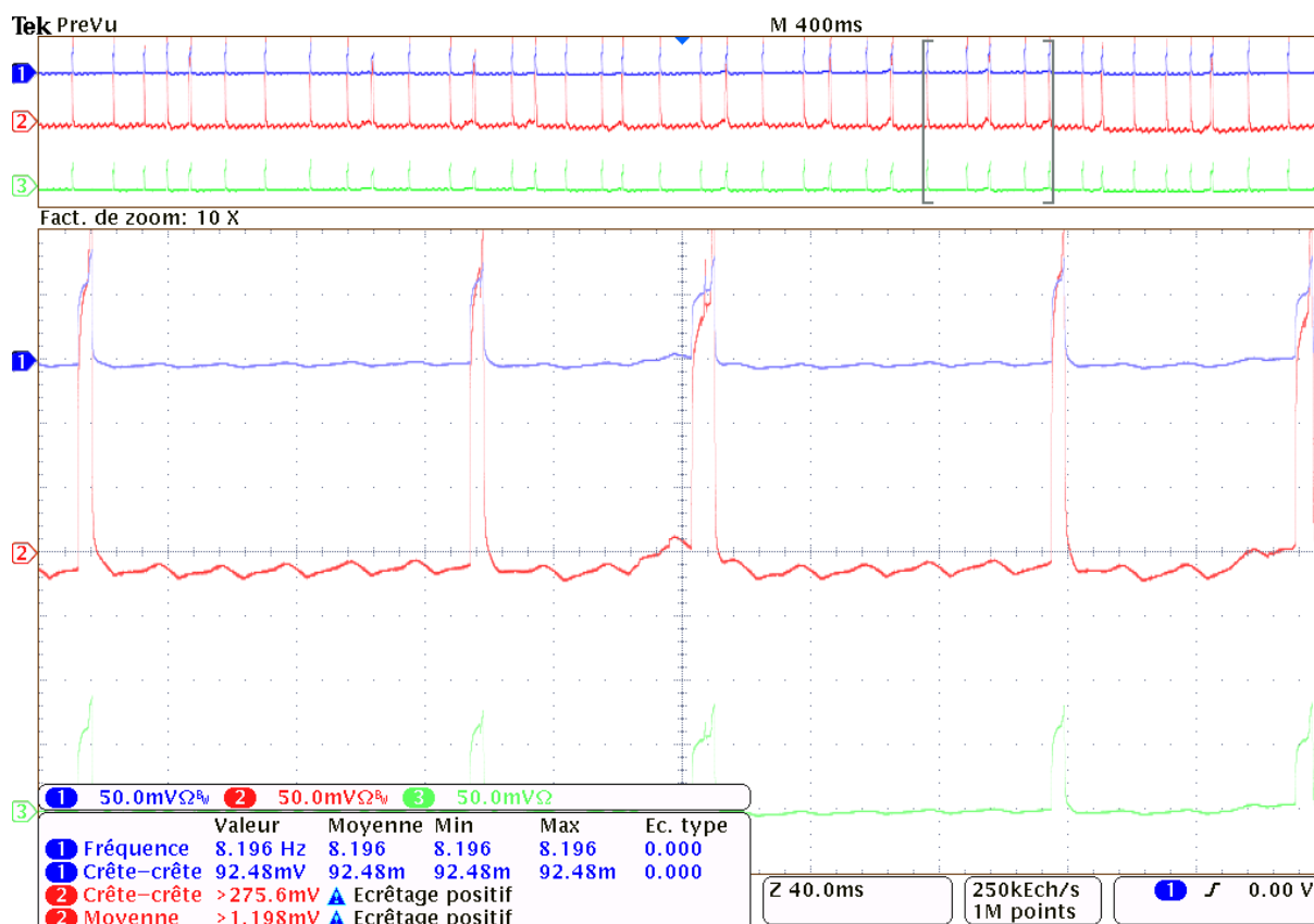
Figure 4.29 : Capture d'écran de l'oscilloscope Tektronix DPO4034 durant la mesure de potentiels d'action ralenti par la présence de GABA dans le milieu de culture
