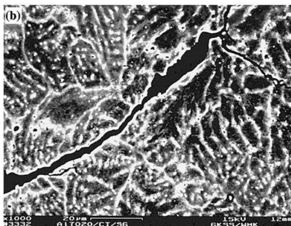
FIGURE 1.14 – Propagation d'une fissure le long des joints de grains de la ZF dans une éprouvette CT (Cam et Kocak, 2007)
