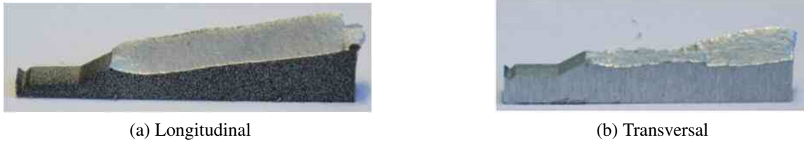
FIGURE 4.39 – Photographies des surfaces de rupture du métal de base à l'état T652 sur éprouvettes Kahn dans les deux sens de prélèvement
