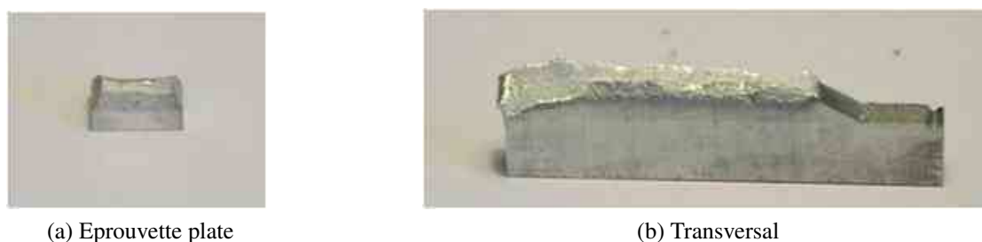
FIGURE 4.44 – Photographies des surfaces de rupture de la zone soudée sur éprouvette plate et sur éprouvette Kahn, état mûri
