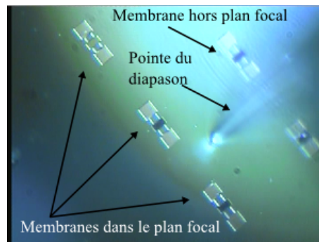
Figure 4.8 - Membrane d'InP imagée par microscopie optique inclinée avec un objectif 20x à grande distance de travail. Le contact outil/membrane est difficile à appréhender uniquement par la vision et certains détails des membranes (voir figure 4.9(a)) sont complètement invisibles.
