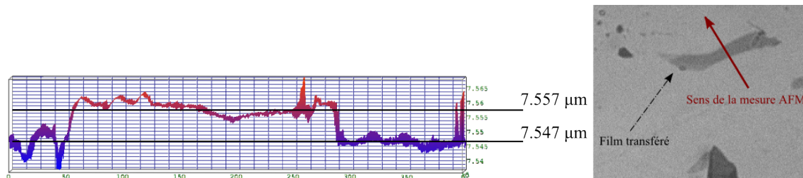
(a) Résultat de la mesure par l'AFM. La hauteur mesurée du film par l'AFM (b) Trajectoire de la mesure est comprise entre 7,557 \mu\text{m} et 7,547 \mu\text{m} soit une épaisseur de 10 nm, environ AFM (flèche rouge). 30 couches.
