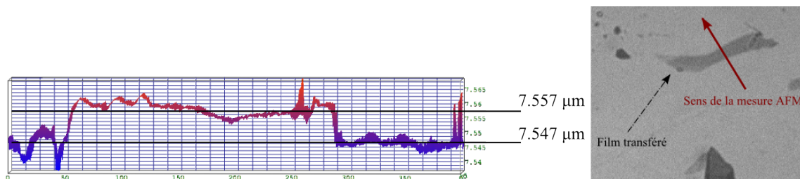
(a) Résultat de la mesure par l'AFM. La hauteur mesurée du film par l'AFM (b) Trajectoire de la mesure est comprise entre 7,557 \mu\text{m} et 7,547 \mu\text{m} soit une épaisseur de 10 nm, environ 30 couches. AFM (flèche rouge).
