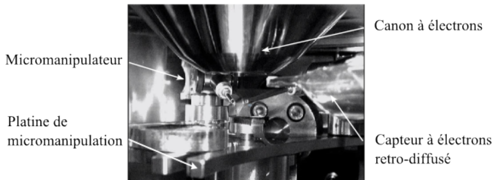
Figure 3.10 - Vue intérieure de la chambre principale d'un MEB. Cette image provient d'une caméra infrarouge disposée dans la chambre. Sur cette image, le canon à électrons ainsi que le capteur pour électrons rétrodiffusés entrave la visibilité de l'opérateur et l'espace de travail du micromanipulateur situé derrière le canon à électrons.
