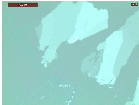
Figure 1.10 - Graphène exfolié mécaniquement, le contraste des couleurs correspond aux différentes couches de graphène - IMPMC
