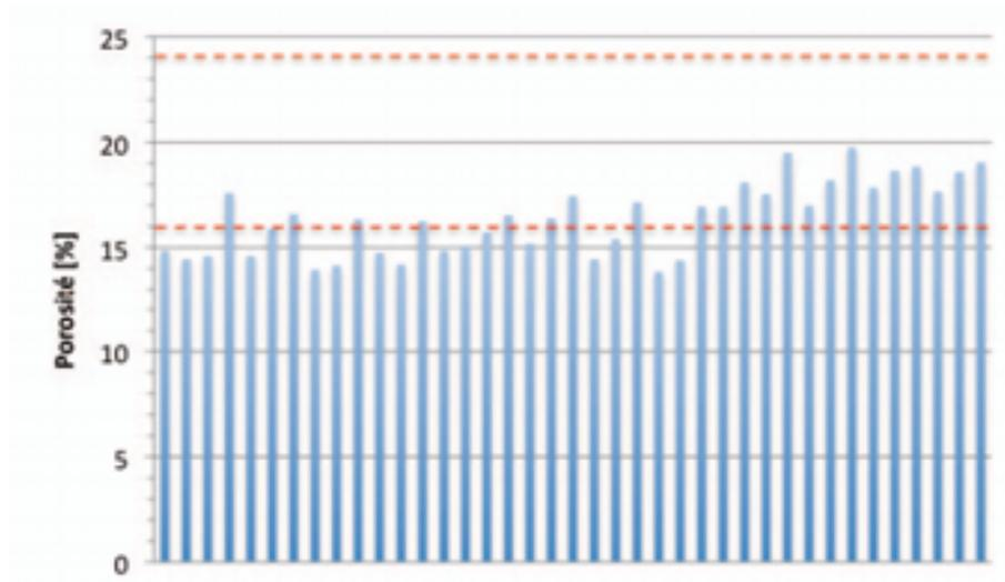
Figure IV-1 : Histogramme des porosités totales à l'eau des 39 échantillons de mortiers ( $E/C = 0,45$ ) issues des 13 compositions et des 3 cures (moyenne des prélèvements vertical et horizontal). La zone délimitée par les lignes en pointillés rouges indique la plage de valeur courantes des porosités de mortiers normalisés ( $E/C = 0,5$ ).
