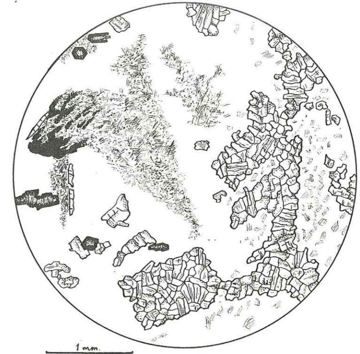
FIG. 41 (pl. m. 72 V). — Gabbro à phénocristaux de plagioclase nombreux. La zone interstitielle triangulaire, entièrement chloritisée et amphibolisée, avec mica et stilpnomélane ou biotite (vert). Les phénocristaux de plagioclase sont transformés en albite, variété d'épidote, phyllite; présence de tourmaline et de deux petites aiguilles d'apatite. Grain d'ilménite déformé et altéré.
