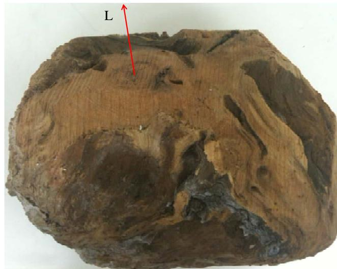
Figure 14 : Loupe de thuya et direction L du tronc de l'arbre
