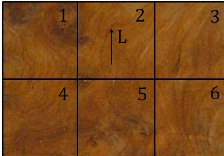
Figure 44 : Variation de la distribution des cernes dans un échantillon parallélépipédique de dimension  $40 \times 40 \times 60 \text{ mm}^3$  et dans les petits échantillons cubiques de 20mm de côté près découpage.
