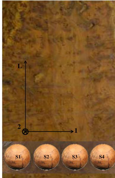
Figure 66 : Confection des échantillons sphériques de loupe de thuya de la seconde série issue du deuxième plateau
