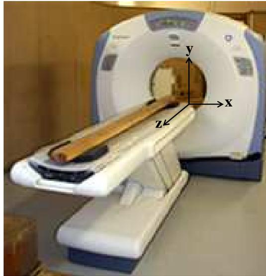
Figure 16 : Scanner à rayons X adapté au matériau bois
