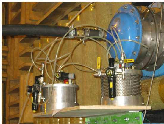
FIGURE 5.5 – Photographie des ensemençeurs. L'un est connecté à la veine primaire via trois tubes d'injection en paroi, l'autre à la veine secondaire via trois cannes d'injection multi-trous.
