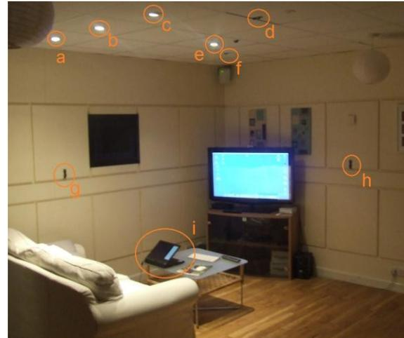
FIGURE 100 – CAPTEURS ET EFFECTEURS MIS EN EVIDENCE DANS LE SALON DE L'ISPACE (EXTRAIT DE (WAGNER, ET AL. 2010 – D15))
