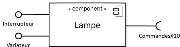
FIGURE 23 - UN COMPOSANT LOGICIEL REPRESENTANT UNE LAMPE CONTROLEE PAR LE PROTOCOLE X10
