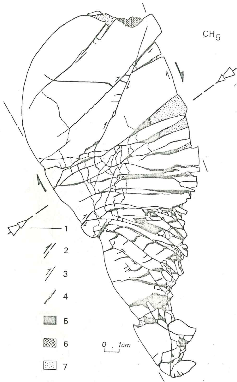
FIGURE 20 : Coupe d'un galet tronçonné à proximité d'un plan de faille. 1-Direction de raccourcissement. 2-Plan de faille externe. 3-Microcisaillement interne. 4-Stylolites. 5-Cristaux de calcite automorphe. 6-Graviers de la matrice. 7-Sables de la matrice.
