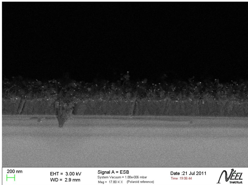
FIGURE 4.22 – Clichés EBSD de la croissance de nanotubes de carbone catalysée par des nanoparticules de nickel ancrées dans du diamant. Les catalyseurs ne sont pas suffisamment ancrées pour empêcher la croissance de type tip growth.
