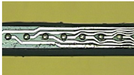
FIGURE 1.8 – Electrode sur pointe (ou axiale) de la FHC inc du Canada.
