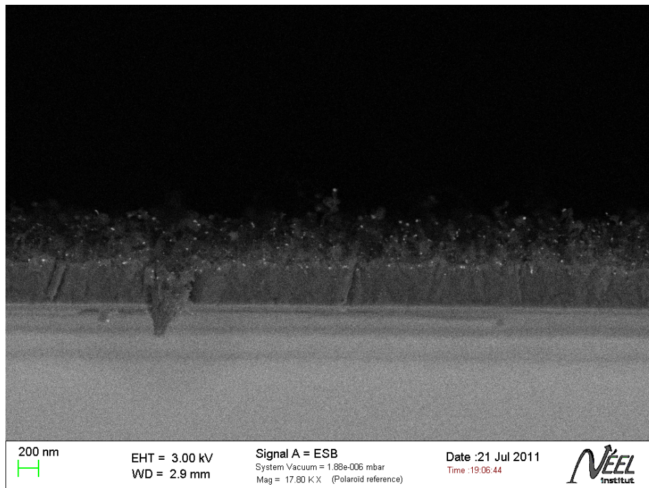
FIGURE 4.21 – Clichés EBSD de le croissance de nanotubes de carbone catalysés par des nanoparticules de palladium insérées dans du diamant. Les catalyseurs sont piégés dans le diamant induisant une croissance de type "base growth".
