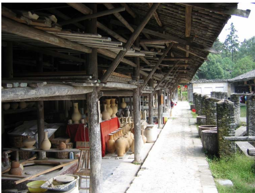
Figure 307 : Vue du hall principal d'un atelier de façonnage, avec les étagères imbriquées (gauche), le couloir (centre) et les bassins (droite), Jingdezhen, 20 octobre 2006. Photographie : N. Balard.
