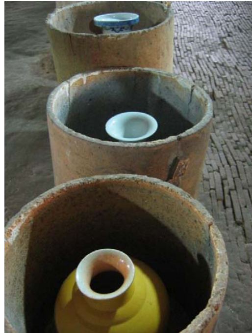
Figure 274 : Disposition des porcelaines dans les cassettes, Jingdezhen, 20 octobre 2006. Photographie : N. Balard.
