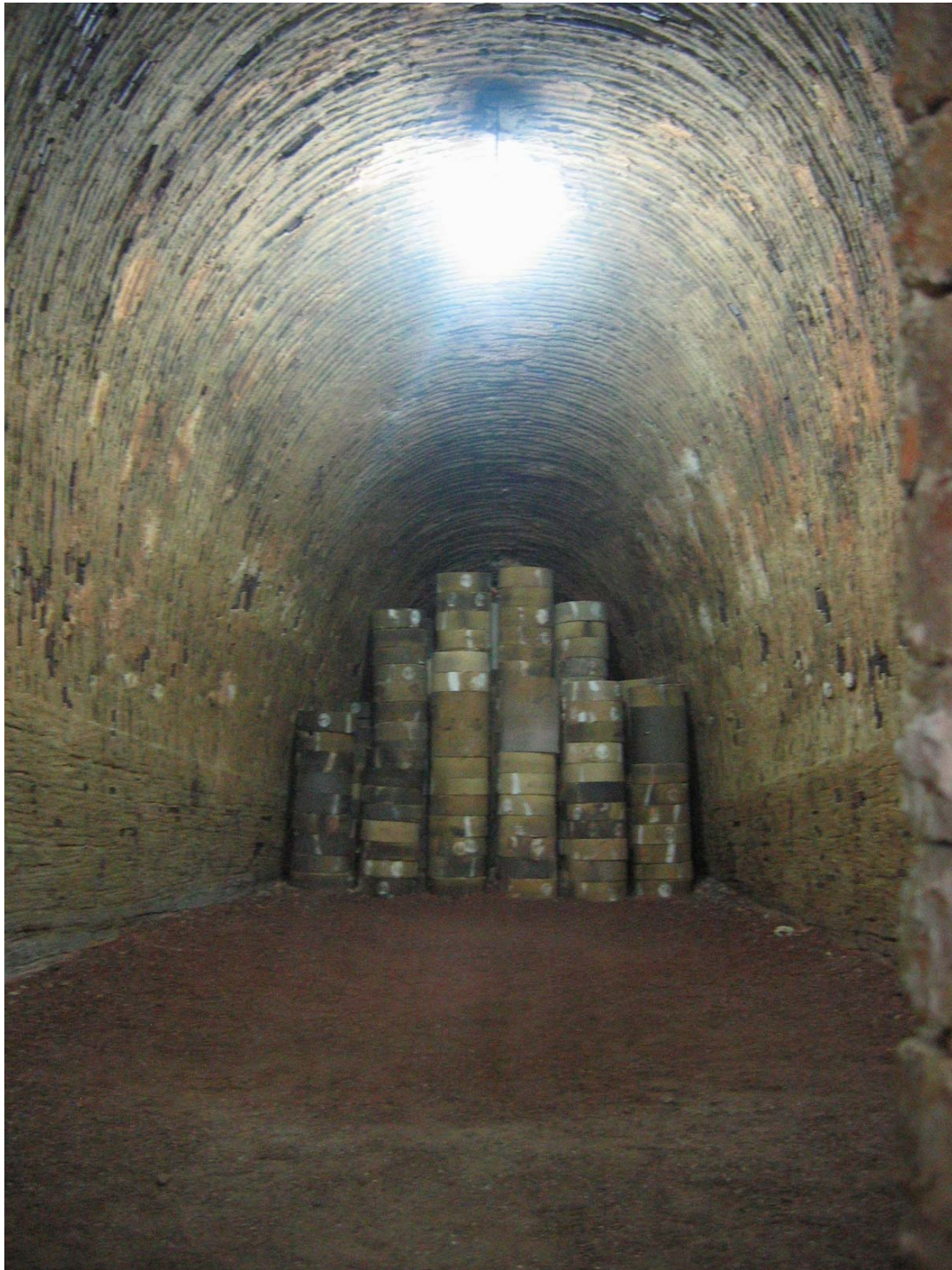
Figure 276 : Disposition de piles de cassettes à l'intérieur d'un four de Jingdezhen, Jingdezhen, 20 octobre 2006. Photographie : N. Balard.
