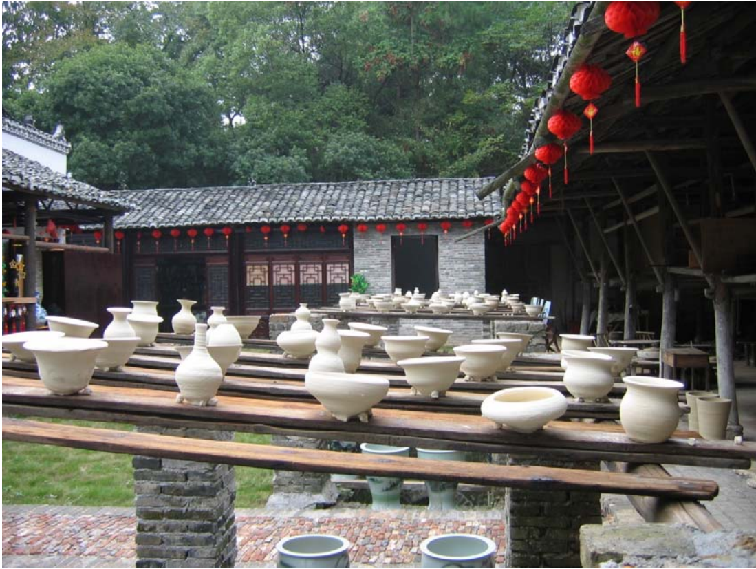
Figure 255 : Pièces crues en train de sécher au-dessus des bassins dans un atelier traditionnel, Jingdezhen, 10 octobre 2006. Photographie : N. Balard.
