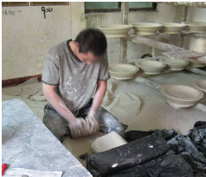
Figure 248 : Malaxage de l'argile, Jingdezhen, 10 avril 2009. Photographie : N. Balard.
