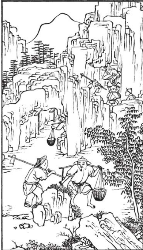
Figure 229 : L'extraction du petuntse . Illustration : Jīngdézhen táolù túshuō 景德镇陶 录图说 (Recueil illustré sur la céramique de Jingdezhen), 1815.
