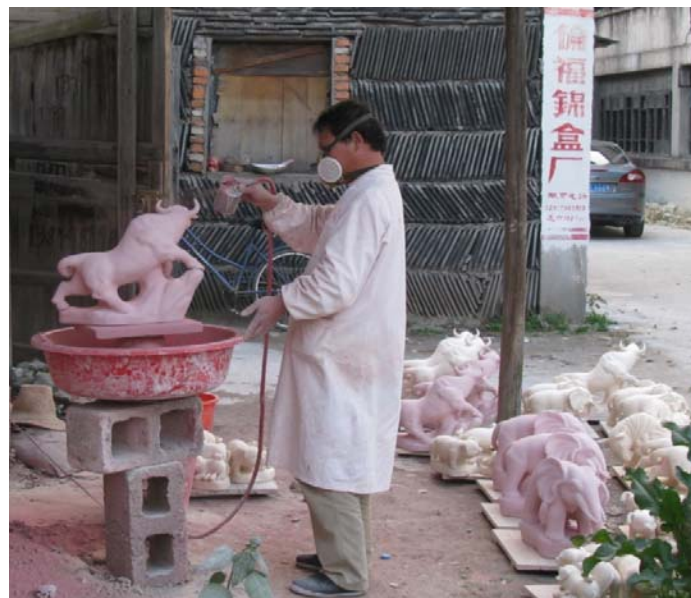
Figure 271 : Pose de la couverte par pulvérisation, Jingdezhen, 10 avril 2009. Photographie : N. Balard.
