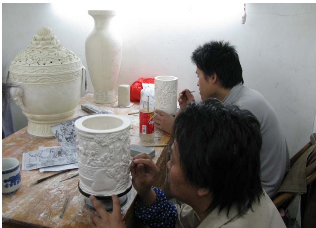
Figure 261 : La pose du décor incisé, Jingdezhen, 11 avril 2009. Photographie : N. Balard.
