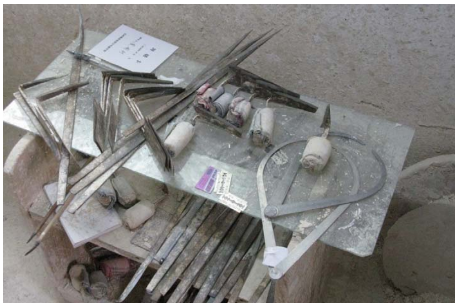
Figure 328 : Outils employés pour gratter les pièces crues lors du tournassage, Jingdezhen, 11 avril 2009. Photographie : N. Balard.
