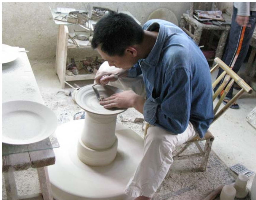
Figure 259 : Le tournassage, Jingdezhen, 11 avril 2009. Photographie : N. Balard.
