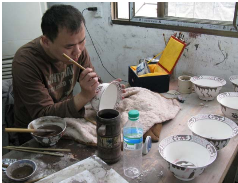
Figure 266 : Peinture sous couverte, Jingdezhen, 11 avril 2009. Photographie : N. Balard.
