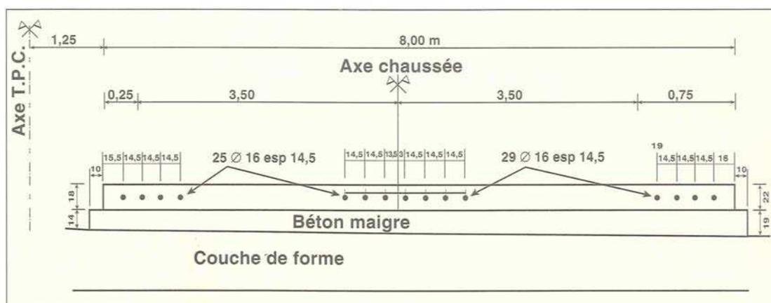
Illustration 7: Profil en travers type de la chaussée en béton du contournement de Moulins.
