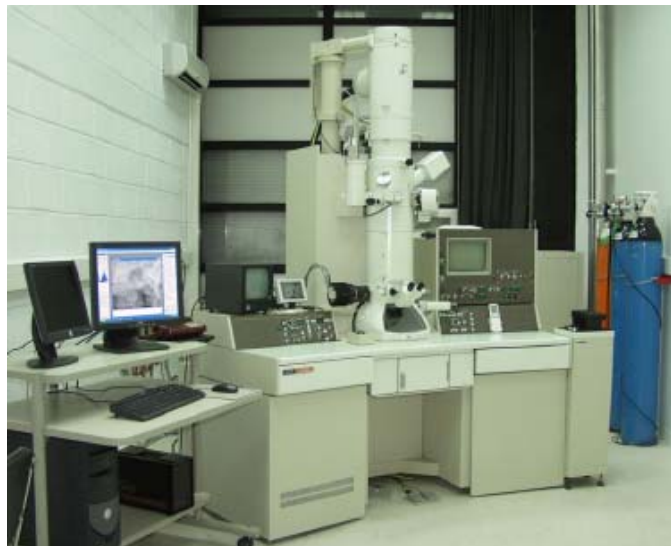
Figure II.10. MET JEOL JEM 2010
