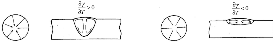
Figure 1.17 - Influence du gradient de tension superficielle sur les écoulements du bain fondu (Zhao, 2011)
