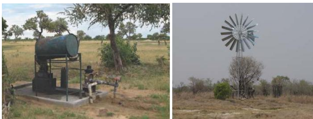
Fig A.3.9 : Deux types de pompes : à gauche une pompe diesel, à droite une pompe éolienne. Source : (Le Pic Vert 2011)
