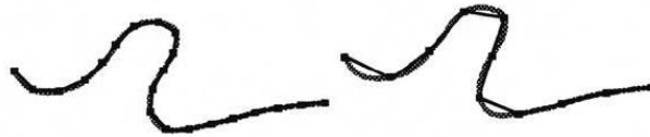
Fig A.2.28 : Une courbe décrite par une succession régulière de points, acquis de manière plus ou moins fréquente. Source : (Ruas et Mustière 2005)
