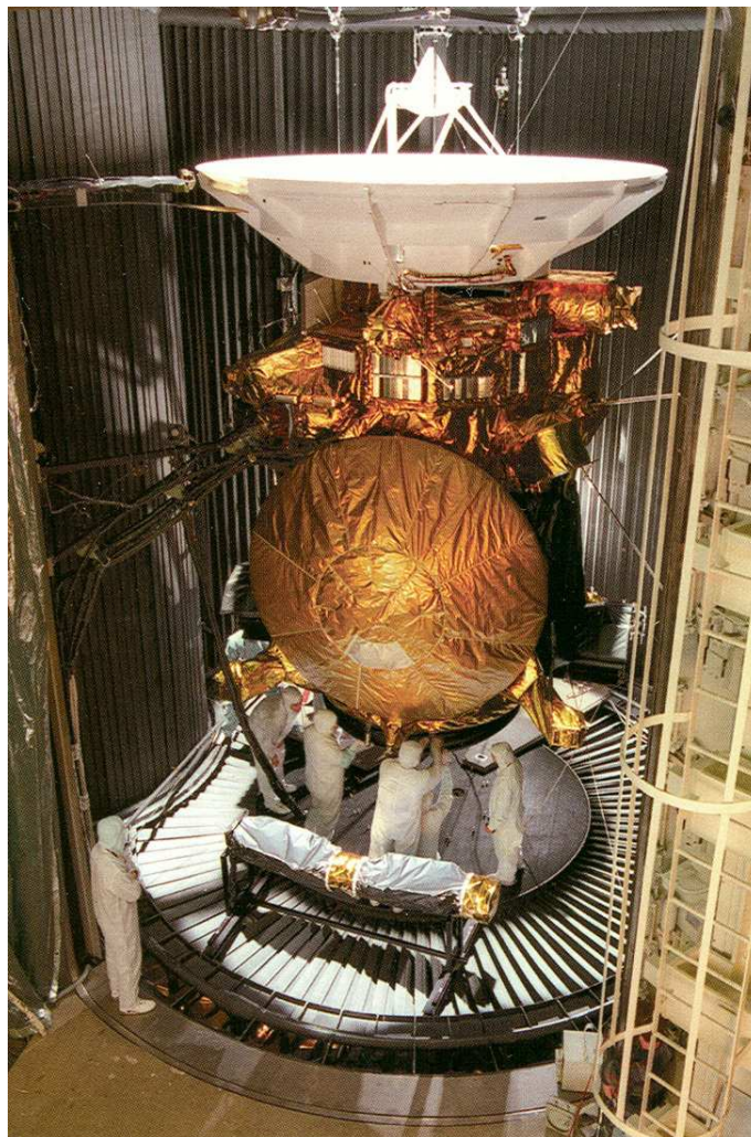
FIGURE 2.2 – La sonde Cassini et le module Huygens. La sonde Cassini mesure 7 m de hauteur. Image : http://www.lesia.obspm.fr , modifiée.
