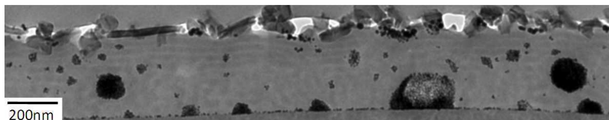
Figure 5.31. Cliché MET-HR du film mince n°2 après recuit thermique
