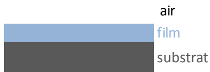
Figure 5.5. Modèle réalisé dans GenX pour déterminer l'épaisseur du film
