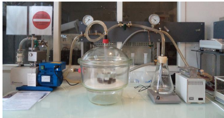
Figure 2.3. a) Schéma du dispositif expérimental de mesure de la porosimétrie à l'eau. b) Photo du dispositif expérimental.
