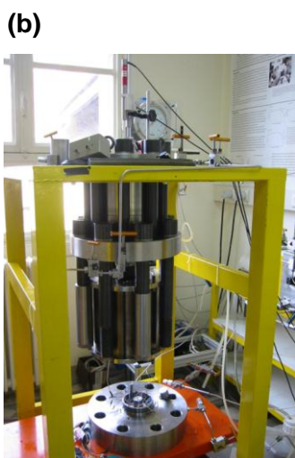
Figure 1.3. (a) Schéma de la cellule triaxiale Geodesing, disponible à l'ENS Paris, (b) Photo de la cellule triaxiale Geodesing, (c) Photo d'un échantillon mis en place pour un essai triaxial.
