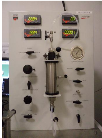
Figure 2.6. Photo du perméamètre Poroperm.
