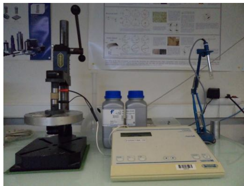
Figure 2.5. a) Schéma du dispositif expérimental de mesure de la conductivité électrique. b) Photo du dispositif expérimental.
