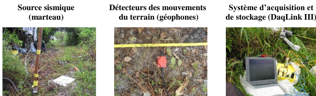
Figure 3.8. Equipements sismiques déployés sur le terrain.
