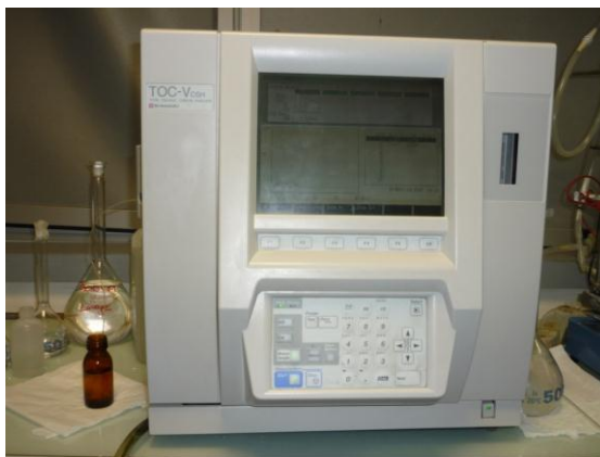
Figure 2.3. Analyseur TOC- V_{CSH} - SHIMADZU
