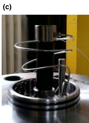
Figure 1.3. (a) Schéma de la cellule triaxiale Geodesing, disponible à l'ENS Paris, (b) Photo de la cellule triaxiale Geodesing, (c) Photo d'un échantillon mis en place pour un essai triaxial.
