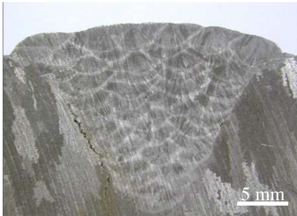
Figure 3.20 : Fissures formées dans les aciers réfractaires moulés au voisinage de la zone de fusion lors de leur réparation par soudage.
