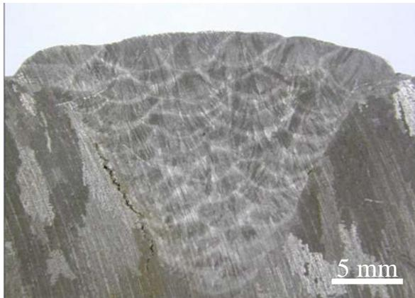
Figure 3.20 : Fissures formées dans les aciers réfractaires moulés au voisinage de la zone de fusion lors de leur réparation par soudage.
