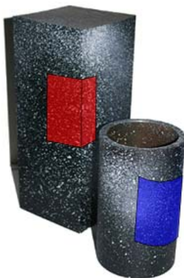
Figure V.8 : Un cylindre et un bloc pour valider la construction d'une surface 3D
