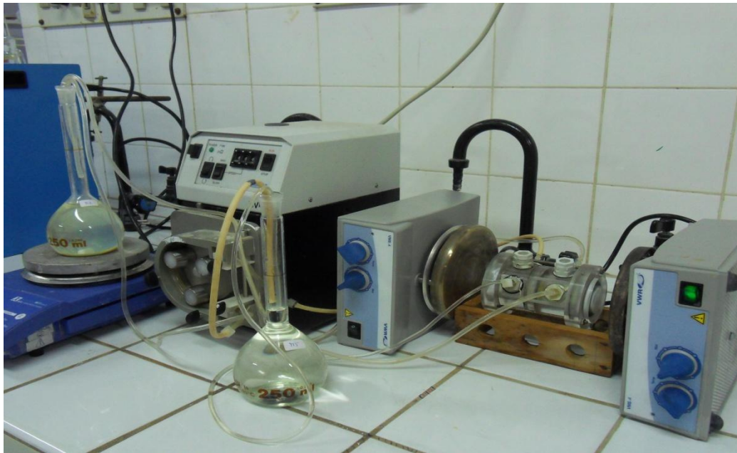
Figure IV- 24 : Montage du procédé obtenu par couplage de la DIC et de l'adsorption sur une alumine activée.
