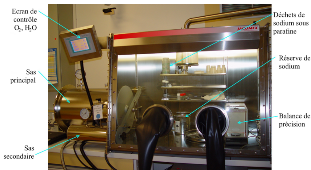
FIGURE 3.13 – Photographie de la boîte à gants utilisée dans cette étude pour la manipulation du sodium.
