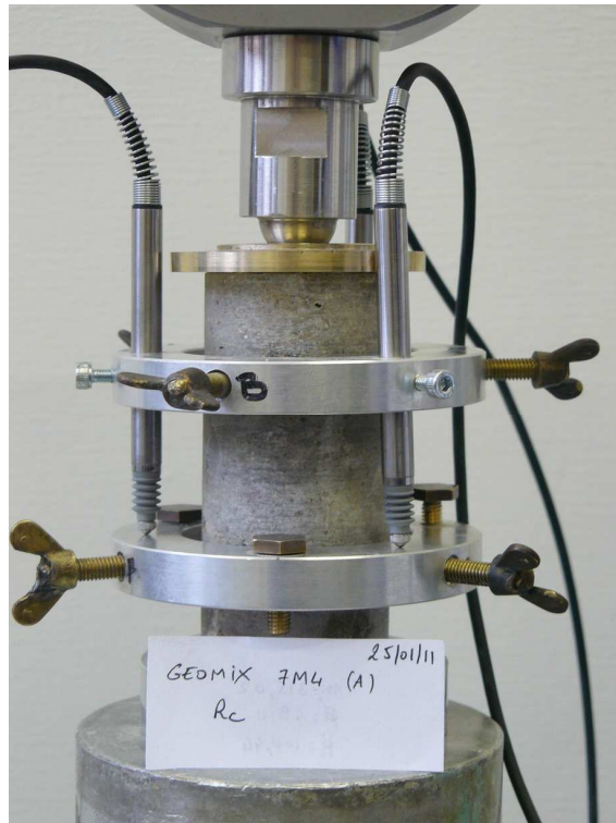
Figure 71 Dispositif de mesure locale de déplacement
