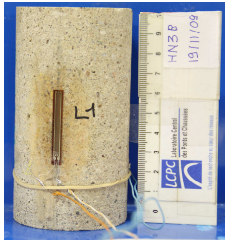
Figure 70 Eprouvette équipée d'une jauge de déformation
